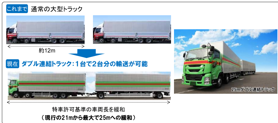
図8 ダブル連結トラックの概要
